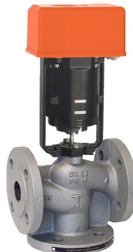
Grauguss-Durchgangsventil RF15..50-BF/RF65K-BF für Stellantrieb MF100/230-SR oder MF100/230-SR-E, für Wasser bis 120 C; 16 bar
